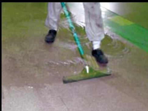
工場の床に ECO Kuratetsu Floor を敷きポリッシャーをかけて下部への水の浸透率をテストしました。いままでのボンド接着施工ですと、ボンドが甘い箇所から下部に水が浸透して汚れた水がジョイント部から浮き出る症状が見られました。ECO Kuratetsu Floor は接着剤を使用しませんので、浸透が激しく浮き出る水が目立つのではとテスト前は懸念していました。テスト結果は全くとは言えませんが、無に等しいくらい浸透はありませんでしたが、施工によっては若干浸透する場合がございますので、水等をこぼされた場合は、タイルをめくって清掃処理を行ってください。
